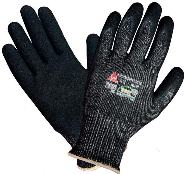
Schnittfester Montagehandschuh Level 5 mit hohem Tragekomfort, Material: Sandyfinish Nitrilbeschichtet, Hybridgarn aus HPPE und Glasfaser, waschbar, nahtlos, Länge: 22-27cm
